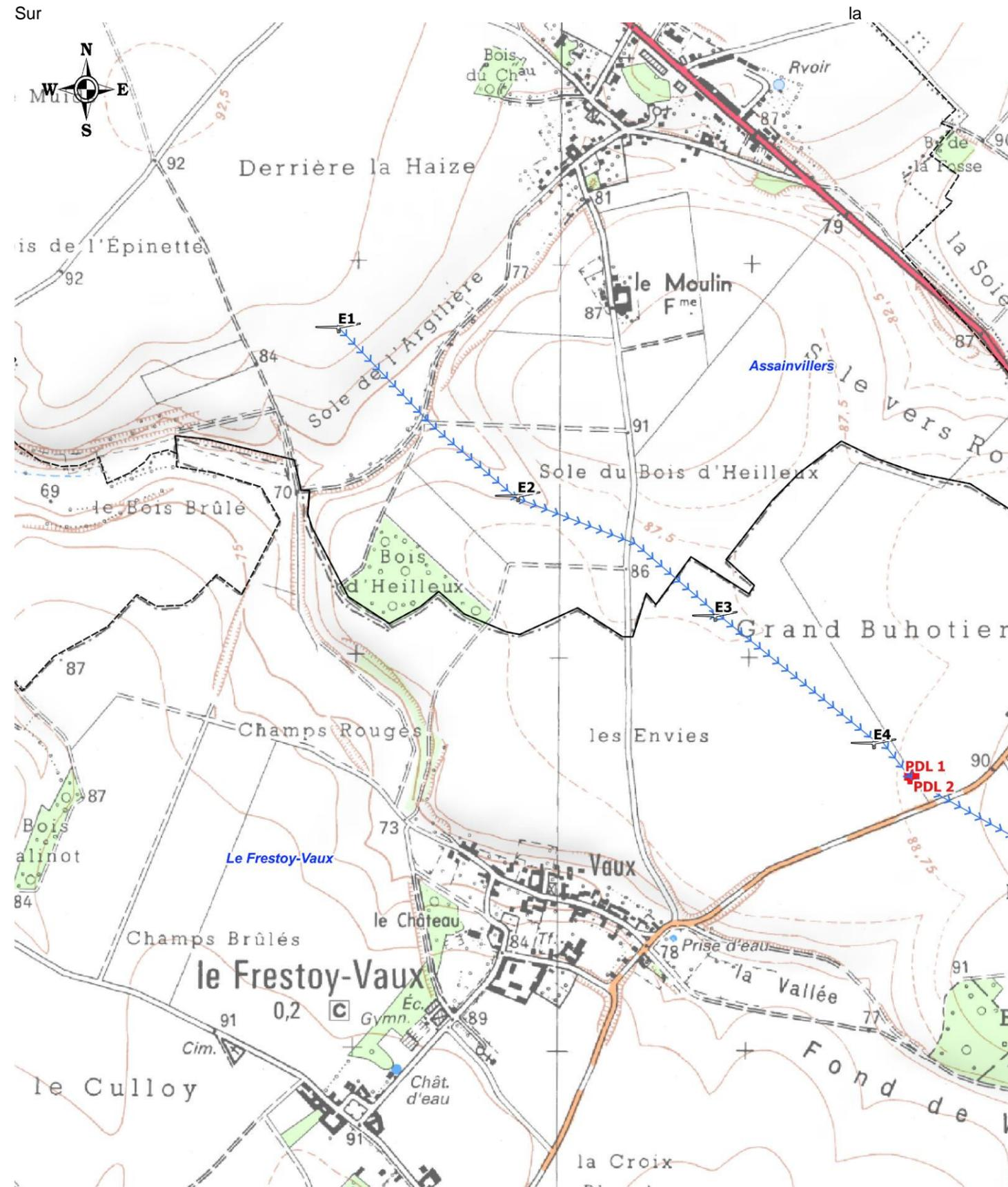
Carte 14 « Réseaux électriques internes à l'installation » est présenté le tracé des câbles de liaison inter-éoliennes et des câbles de liaison jusqu'aux postes de livraison.
